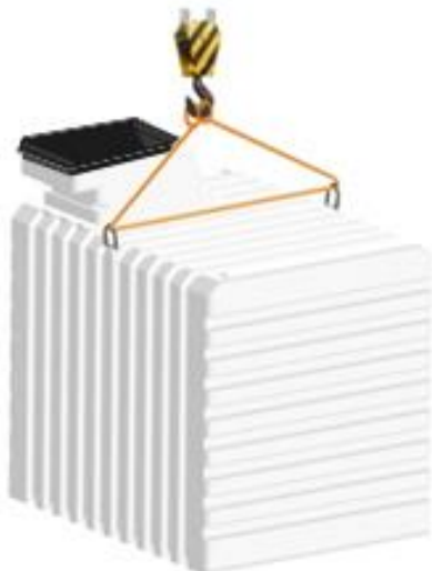
Рисунок 2. Крепление стропой 2СК-1,0
