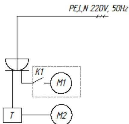
*M1 – двигатель насоса принудительного отведения стоков
