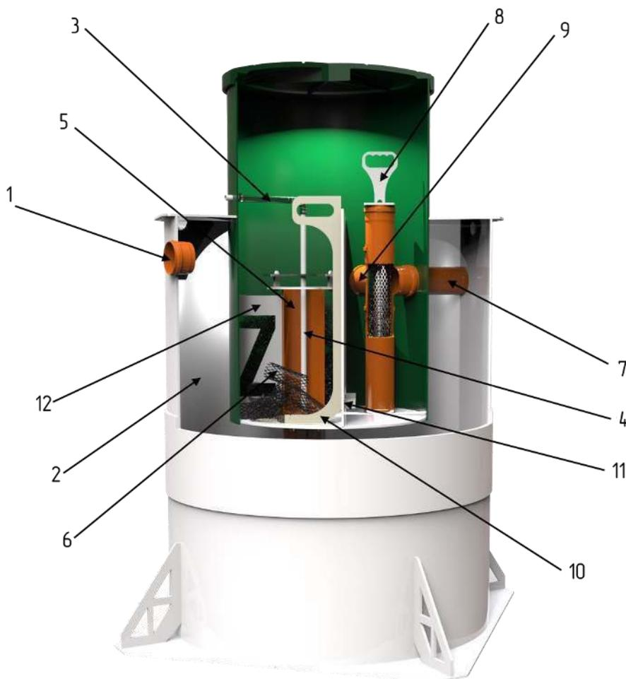
Через входной патрубок (1) сточная вода поступает в камеру очистного сооружения (2), где начинается первый бескислородный этап биологической очистки бактериями активного ила. Далее через пневматический шланг (3) подаётся воздух на аэратор (4) с помощью которого сточные воды, расположенные в восходящей трубе (5) насыщаются кислородом, а также создается восходящий поток сточных вод в трубе (5).
